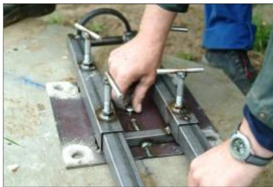
Positionner le gabarit en mettant une vis ou une broche dans le trou de centrage
